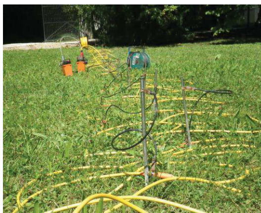
Système Lund ABEM et résistivimètre SAS 4000 (matériel propre CPGF-HORIZON)
