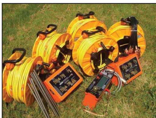
Système Lund ABEM et résistivimètre SAS 4000 (matériel propre CPGF-HORIZON)
